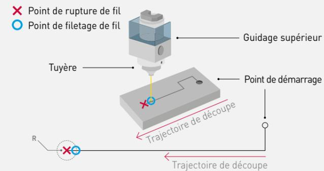
Contrairement à d'autres machines, la ROBOCUT n'a pas besoin de retourner au point de départ après une rupture de fil. Une réduction considérable du temps d'usinage est obtenue en re-enfilant le fil automatiquement dans la saignée sur des pièces allant jusqu'à 150 mm.
