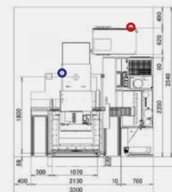
\*1) Le plan de sol ci-dessus est celui d'une machine de type standard. Contactez FANUC si vous souhaitez commander des options telles que l'axe Z 410 mm, 510 mm et le chargeur de fil de 30 kg.
