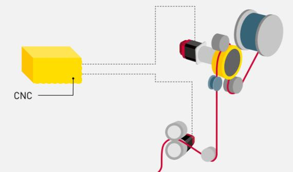
Deux servomoteurs assurent la tension mécanique du fil. Grâce à la technologie numérique de servocommande de FANUC, le contrôle de fil par double servocommande garantit une découpe régulière en supprimant les variations de tension du fil. Parmi les autres avantages, moins de ruptures de fil et d'usure de pièces.
